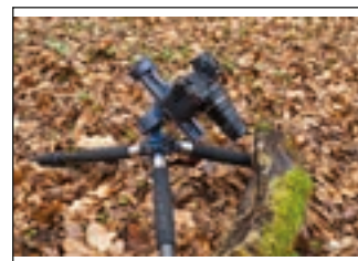
ZRT3853.jpg CASTEL-M auf TrioPod-M mit Kugelkopf MagicBall, Nikon- kamera und Laowa 25mm f/2.8 2.5-5x Ultra Macro
